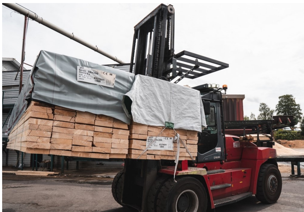
Bergene Holm har i samarbeid med Looping byttet ut engangsplastfolien med gjenbrukbare presenninger
