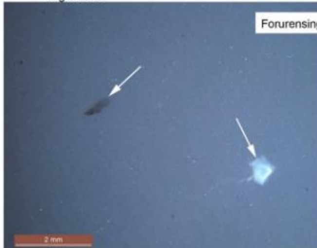
Figur 3. SM bilde av overflaten til malingspann tilsatt 100% regranulat.
