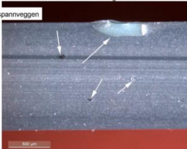
Figur 2a. SM bilde av mikrotomert tverrsnitt av spennveggen hvor det er tilsatt 100% regranulat
