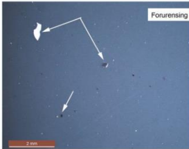
Figur 2. SM bilde av overflaten til malingspann tilsatt 50% regranulat.
